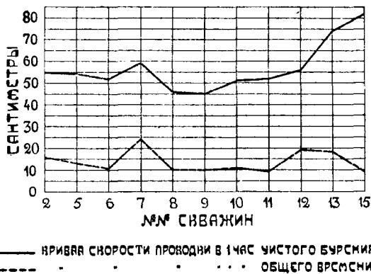
Фиг. 50. Диаграмма скоростей проходки в осадочных породах.
